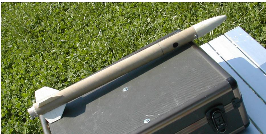
Modellrakete mit D12-5-Motor und einer Pencam an Bord
