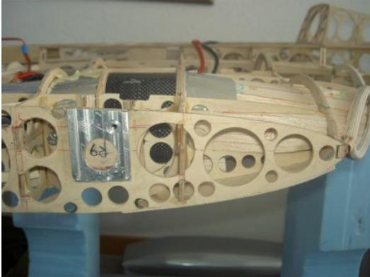
Der Aussenflügel und das Heck sind durch Alu-Teile mit T-Nute und M4- Schrauben am Mittelflügel kraftschlüssig befestigt
