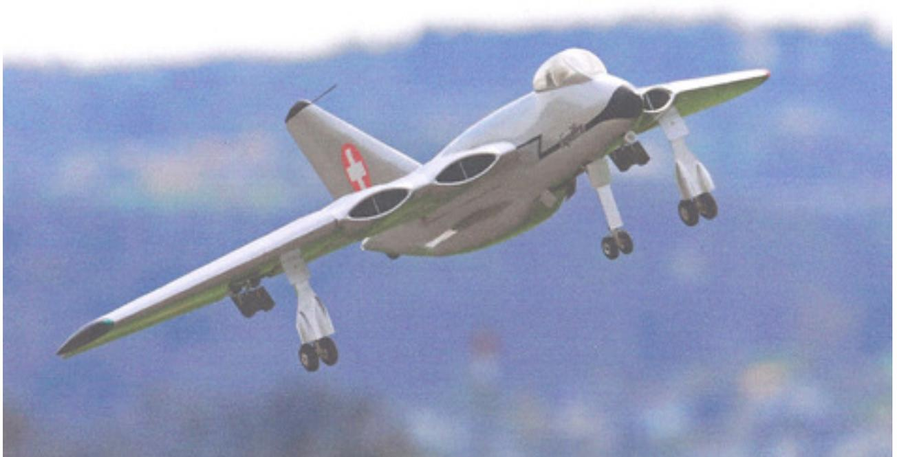
Der Erstflug war ziemlich instabil und forderte dem Piloten *Nello Nero* alle Geschicklichkeit ab. Der durchströmte Flügel muss eine andere Auftriebsverteilung ergeben als eine geschlossene Rippenfläche d.h. der Schwerpunkt ist beim Original auch zu weit hinten angelegt
