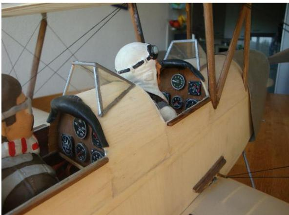
Fahrwerks verkleidete ich mit gebeiztem Balsa, so dass sie wie aus altem Holz wirken. Die beiden Sitzplätze der Pilotin und des Piloten beizte ich auch und versah sie mit ein paar gekauften Plastik-Instrumenten.
