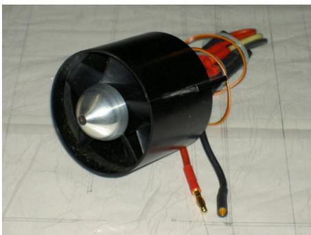
Das Modell der Thunderjet wird von einem Elektro-Impeller angetrieben. Dabei dreht ein Elektromotor einen ummantelten Fan, der die eintretende Luft durch das Schubrohr auf hohe Geschwindigkeit beschleunigt. Dadurch wird der Vortrieb erzeugt vergleichbar mit einem modernen Strahltriebwerk. Der Impeller hat eine Leistung von 500W und erzeugt eine Strahlgeschwindigkeit von über 200 km/h. Als
