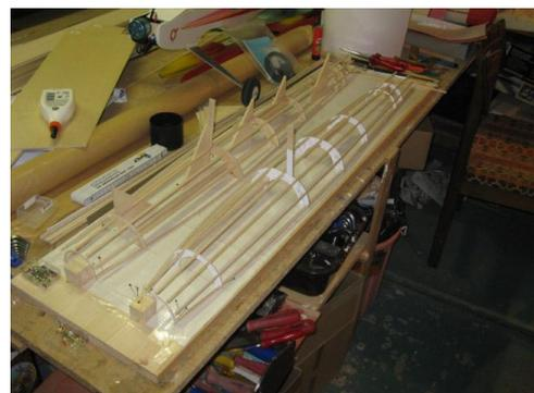
von Balsaholz und bildet die sichtbare Aussenkontur des Rumpfes. In den Rumpf wurden noch Zugangsklappen für den Antrieb und die Elektronik ausgeschnitten.
